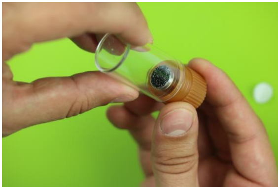
Abb. 5: Verschließen des Stempels mit Probe
