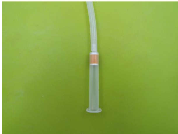
Abbildung 1: DNPH Kartusche verbunden mit Probenahmeschlauch
