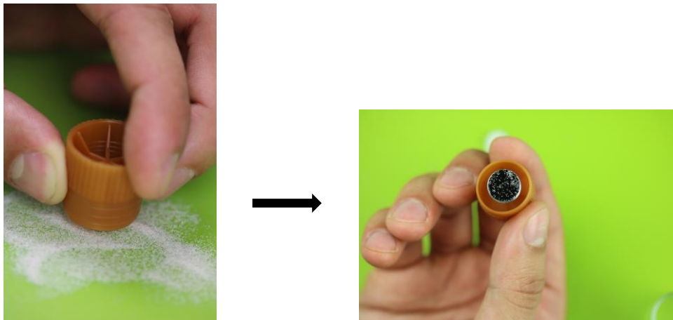
Abb. 4: Stempeln der Probe
