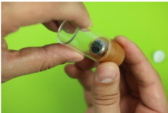
Abb. 5: Verschließen des Stempels mit Probe
